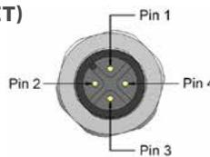
PLEASE USE ONLY SHIELDED SUPPLY CABLES AND SET THE SCREEN ON ONE SIDE (TO AVOID GROUND LOOPS)!
