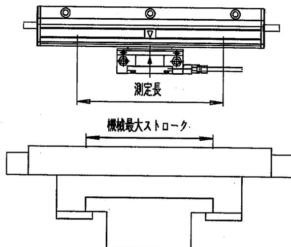
最大可動長を越えてスケールを動かしますとスケールが破損します。
