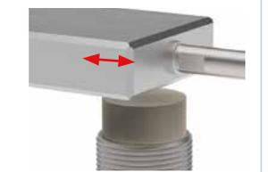
Schichtdickenmessung von nichtleitfähigen Schichten wie Pulverbeschichtungen, Lacken. Prüfung von Kunststoffspritzgussteilen bei umspritzten Metallteilen.
