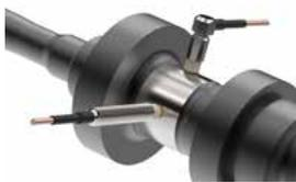
Verformung, Vibration und Schwingung von Zahnrädern während des Betriebes. Axialschubmessung an schrägverzahnten Stirnrädern unter Last. Erkennung von Zahnausbrüchen.
