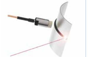
Messung von Gehäuseverformung unter Last stehender Maschinen wie z. B. Getriebe, Motoren, Turbogeneratoren und dgl. Torsionsschwingungsmessung an Wellen und Gehäusen. Messung thermischer Ausdehnung.
